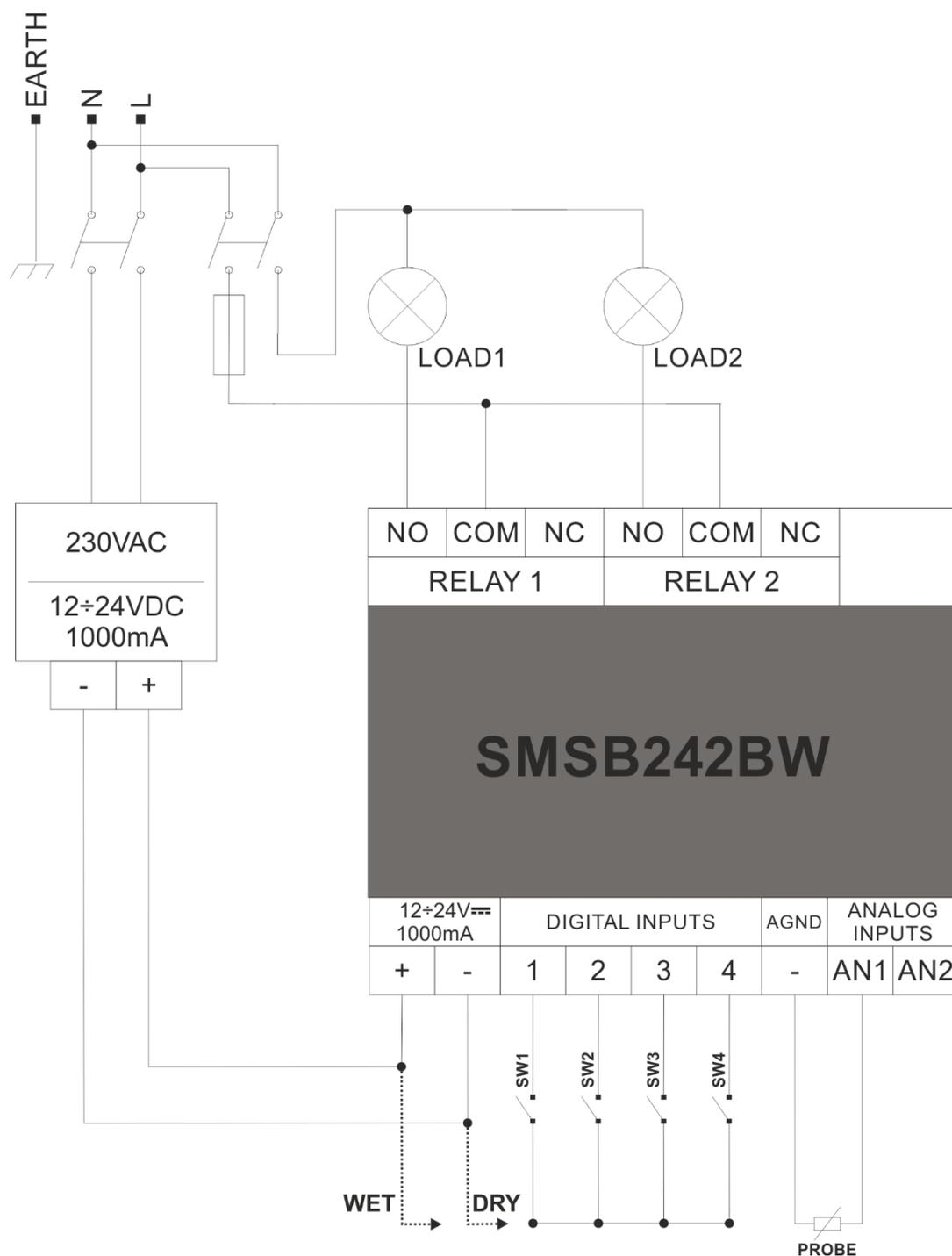
Contact mécanique hors tension, p. ex. pressostat, interrupteur commandé par température, interrupteur de fin de course, bouton-poussoir, sortie relais
